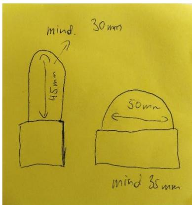
Der Bügel sollte eine Höhe von zwischen 30 mm und 45 mm haben oder zwischen 35 mm und 50 mm breit sein.
